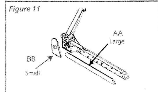
8. Das coupler piece und den support arms richtig anbringen (ca. 1 cm. von coverscharnier), indem sie die #10 selbstdrehenden Schrauben (N) benutzen, verbinden sie den support arms mit dem pivot arm und das coupler piece mit dem support arm (siehe Fig. 7). Anmerkung: Versichern sie sich, dass sie das coupler piece so drehen, dass sich die Schrauben im horizontaler Winkel mit dem Schraubenkopf in Richtung der Rückseite des Spa befinden.
